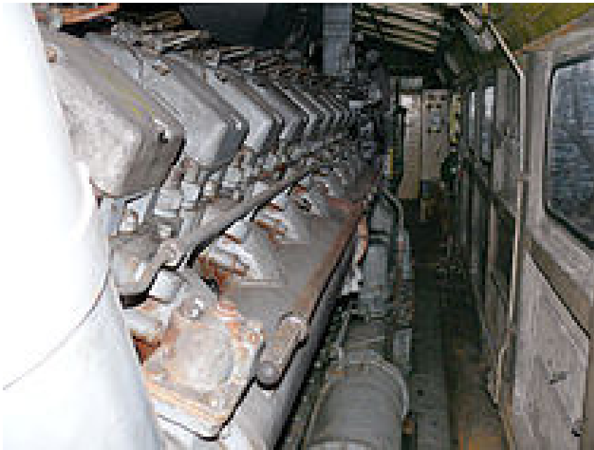
Dieselmotor 5D49 vom Führerstand 2 aus gesehen
