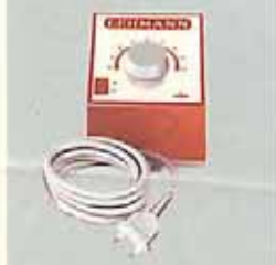
5000/N Transformator (im Außenbetrieb nur mit Super- fahrregler 5012 verwendbar) Anschluß 220 V- regulär Gesamtleistung 2,0 A, 33 VA Fahrlstrom 3-17 V 1,0 A, 17 VA Licht- und Schalt- spannung 14 V-, 1,0 A, 14 VA
