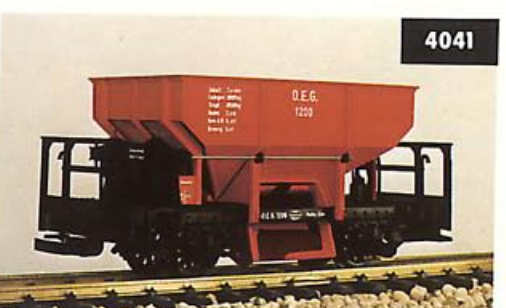
Schotterwagen der OEG, LüP 300 mm Die Entleerung des Schüttgutes erfolgt durch seitliche Klappen, wie beim Vorbild.
